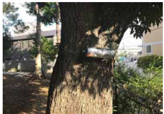
写真 1 データロガーの設置例
